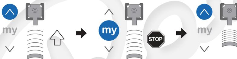
Wenn die Außenjalousie den Schaltfühler berührt, bestätigt sie mit einer kurzen Auf-/Abbewegung und die obere Endlage wird ca. 6 mm unterhalb des Schaltfühlers gespeichert.
