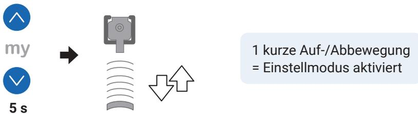
2. Halten Sie die Taste ▲ gedrückt (1 kurze Bewegung) und drücken Sie bei Annäherung an die Endlage die Taste **my**, um den Antrieb zu stoppen. Drücken Sie dann mehrmals kurz die Taste ▲, bis die gewünschte obere Endlage erreicht ist.
